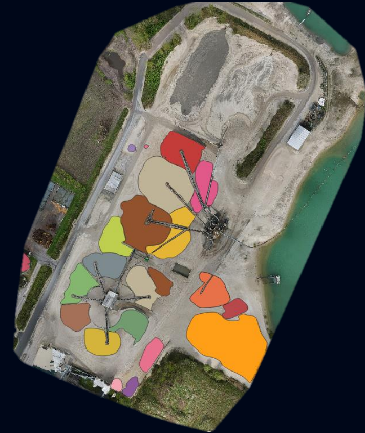
Automatische Segmentierung und Vermessung von Schüttgut
